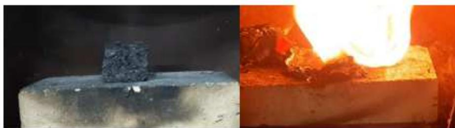
Рисунок 2 – Горение брикета с полиэтиленом.
